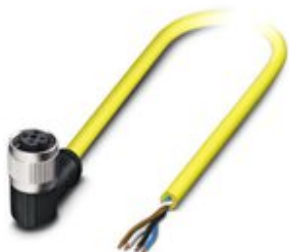
Sensor-/Aktor-Kabel, 4-polig, PVC, gelb, freies Leitungsende, auf Buchse gewinkelt M12, Kodierung: A, Kabellänge: 5 m
