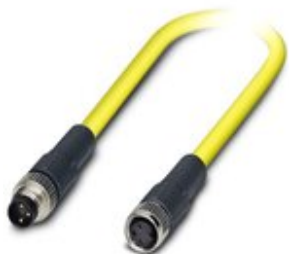
Sensor-/Aktor-Kabel, 3-polig, PVC, gelb, Stecker gerade M8, auf Buchse gerade M8, Kabellänge: 1,5 m
