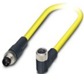
Sensor-/Aktor-Kabel, 3-polig, PVC, gelb, Stecker gerade M8, auf Buchse gewinkelt M8, Kabellänge: 0,5 m
