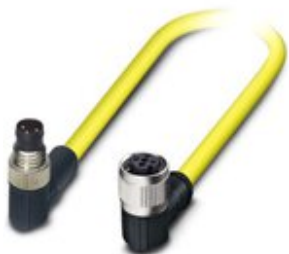
Sensor-/Aktor-Kabel, 3-polig, PVC, gelb, Stecker gewinkelt M8, auf Buchse gewinkelt M12, Kodierung: A, Kabellänge: 1,5 m
