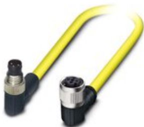
Sensor-/Aktor-Kabel, 3-polig, PVC, gelb, Stecker gewinkelt M8, auf Buchse gewinkelt M12, Kodierung: A, Kabellänge: 0,5 m
