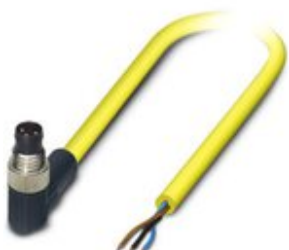
Kabel czujnika/urządzenia wykonawczego, 3-bieg., PCW, żółty, Wtyki kątowe M8, na wolny koniec przewodu, długość kabla: 10 m
