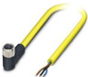
Sensor-/Aktor-Kabel, 3-polig, PVC, gelb, freies Leitungsende, auf Buchse gewinkelt M8, Kabellänge: 10 m
