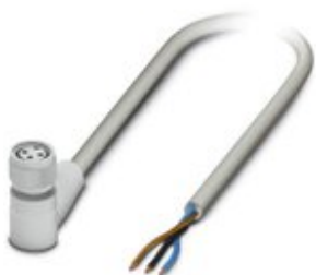
Sensor-/Aktor-Kabel, 3-polig, PP-EPDM halogenfrei, grau RAL 7035, freies Leitungsende, auf Buchse gewinkelt M8, mit 2 LEDs, Kabellänge: 3 m, Hygienic Design, mit Kunststofffrädel
