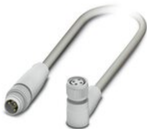
Sensor-/Aktor-Kabel, 3-polig, PP-EPDM halogenfrei, grau RAL 7035, Stecker gerade M8, auf Buchse gewinkelt M8, Kabellänge: 0,3 m, Hygienic Design, mit Kunststofffrädel
