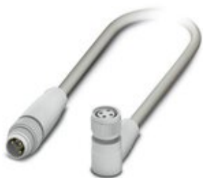
Sensor-/Aktor-Kabel, 3-polig, PP-EPDM halogenfrei, grau RAL 7035, Stecker gerade M8, auf Buchse gewinkelt M8, mit 2 LEDs, Kabellänge: 3 m, Hygienic Design, mit Kunststoffrändel
