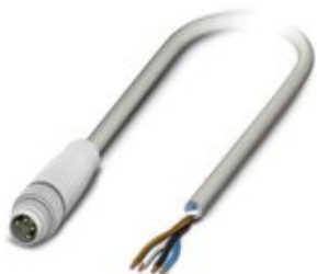
Sensor-/Aktor-Kabel, 4-polig, PP-EPDM halogenfrei, grau RAL 7035, Stecker gerade M8, auf freies Leitungsende, Kabellänge: 5 m, Hygienic Design, mit Kunststofffrädel
