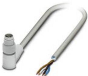
Sensor-/Aktor-Kabel, 4-polig, PP-EPDM halogenfrei, grau RAL 7035, Stecker gewinkelt M8, auf freies Leitungsende, Kabellänge: 10 m, Hygienic Design, mit Kunststofffrändefel
