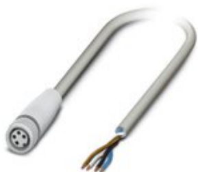
Sensor-/Aktor-Kabel, 4-polig, PP-EPDM halogenfrei, grau RAL 7035, freies Leitungsende, auf Buchse gerade M8, Kabellänge: 3 m, Hygienic Design, mit Kunststofffrädel
