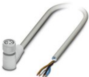
Sensor-/Aktor-Kabel, 4-polig, PP-EPDM halogenfrei, grau RAL 7035, freies Leitungsende, auf Buchse gewinkelt M8, Kabellänge: 10 m, Hygienic Design, mit Kunststoffrändel
