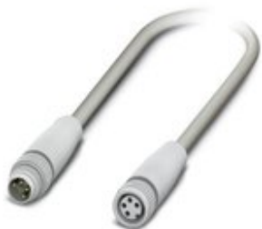
Sensor-/Aktor-Kabel, 4-polig, PP-EPDM halogenfrei, grau RAL 7035, Stecker gerade M8, auf Buchse gerade M8, Kabellänge: 0,3 m, Hygienic Design, mit Kunststofffrädel
