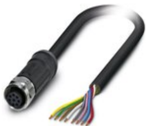
Sensor-/Aktor-Kabel, 8-polig, PE-X halogenfrei, schwarzgrau RAL 7021, freies Leitungsende, auf Buchse gerade M12, Kodierung: A, Kabellänge: 5 m, für Außenanwendungen, mit Edelstahlrändel
