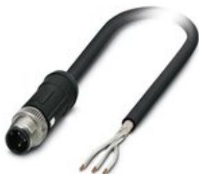
Sensor-/Aktor-Kabel, 3-polig, PE-X halogenfrei, schwarz, geschirmt, Stecker gerade M12 SPEEDCON, Kodierung: A, auf freies Leitungsende, Kabellänge: 2 m, für Bahnanwendungen
