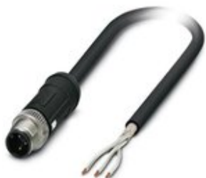
Sensor-/Aktor-Kabel, 3-polig, PE-X halogenfrei, schwarz, geschirmt, Stecker gerade M12 SPEEDCON, Kodierung: A, auf freies Leitungsende, Kabellänge: 5 m, für Bahnanwendungen
