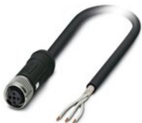
Sensor-/Aktor-Kabel, 3-polig, PE-X halogenfrei, schwarz, geschirmt, freies Leitungsende, auf Buchse gerade M12 SPEEDCON, Kodierung: A, Kabellänge: 10 m, für Bahnanwendungen
