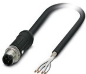
Sensor-/Aktor-Kabel, 4-polig, PE-X halogenfrei, schwarz RAL 9005, geschirmt, Stecker gerade M12 SPEEDCON, Kodierung: A, auf freies Leitungsende, Kabellänge: 2 m, für Bahnanwendungen
