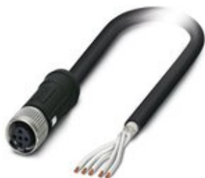
Sensor-/Aktor-Kabel, 5-polig, PE-X halogenfrei, schwarz, geschirmt, freies Leitungsende, auf Buchse gerade M12 SPEEDCON, Kodierung: A, Kabellänge: 2 m, für Bahnanwendungen
