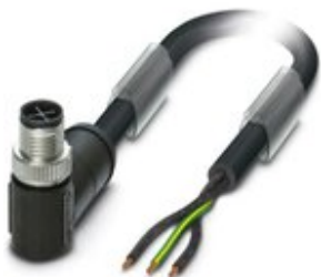
Powerleitung, 3-polig, PVC, schwarz, Stecker gewinkelt M12, Kodierung: S, auf freies Leitungsende, Kabellänge: 5 m, für Wechselstrom bis 16 A / 230 V
