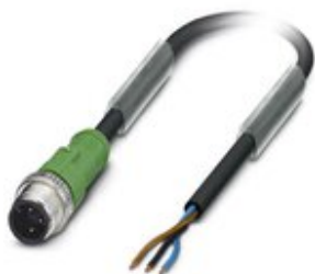
Sensor-/Aktor-Kabel, 3-polig, PVC, schwarz RAL 9005, Stecker gerade M12, Kodierung: A, auf freies Leitungsende, Kabellänge: 10 m
