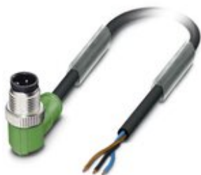
Sensor-/Aktor-Kabel, 3-polig, PVC, schwarz RAL 9005, Stecker gewinkelt M12, Kodierung: A, auf freies Leitungsende, Kabellänge: 3 m
