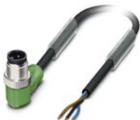
Sensor-/Aktor-Kabel, 3-polig, PVC, schwarz RAL 9005, Stecker gewinkelt M12, Kodierung: A, auf freies Leitungsende, Kabellänge: 5 m
