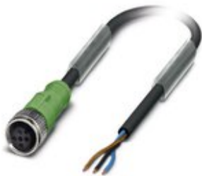
Sensor-/Aktor-Kabel, 3-polig, PVC, schwarz RAL 9005, freies Leitungsende, auf Buchse gerade M12, Kodierung: A, Kabellänge: 1,5 m
