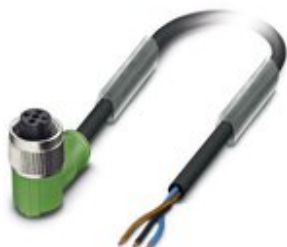
Sensor-/Aktor-Kabel, 3-polig, PVC, schwarz RAL 9005, freies Leitungsende, auf Buchse gewinkelt M12, Kodierung: A, Kabellänge: 1,5 m
