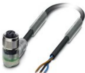
Sensor-/Aktor-Kabel, 3-polig, PVC, schwarz RAL 9005, freies Leitungsende, auf Buchse gewinkelt M12, Kodierung: A, mit 2 LEDs, Kabellänge: 1,5 m
