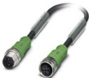
Sensor-/Aktor-Kabel, 3-polig, PVC, schwarz RAL 9005, Stecker gerade M12, Kodierung: A, auf Buchse gerade M12, Kodierung: A, Kabellänge: 0,6 m
