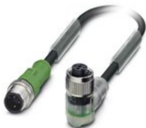
Sensor-/Aktor-Kabel, 3-polig, PVC, schwarz RAL 9005, Stecker gerade M12, Kodierung: A, auf Buchse gewinkelt M12, Kodierung: A, mit 2 LEDs, Kabellänge: 0,3 m
