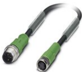
Sensor-/Aktor-Kabel, 3-polig, PVC, schwarz RAL 9005, Stecker gerade M12, Kodierung: A, auf Buchse gerade M8, Kabellänge: 1,5 m
