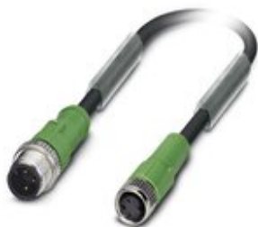
Sensor-/Aktor-Kabel, 3-polig, PVC, schwarz RAL 9005, Stecker gerade M12, Kodierung: A, auf Buchse gerade M8, Kabellänge: 3 m
