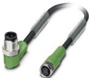
Sensor-/Aktor-Kabel, 3-polig, PVC, schwarz RAL 9005, Stecker gewinkelt M12, Kodierung: A, auf Buchse gerade M8, Kabellänge: 1,5 m
