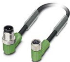
Sensor-/Aktor-Kabel, 3-polig, PVC, schwarz RAL 9005, Stecker gewinkelt M12, Kodierung: A, auf Buchse gewinkelt M8, Kabellänge: 0,3 m
