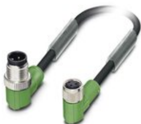
Sensor-/Aktor-Kabel, 3-polig, PVC, schwarz RAL 9005, Stecker gewinkelt M12, Kodierung: A, auf Buchse gewinkelt M8, Kabellänge: 0,6 m
