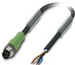
Sensor-/Aktor-Kabel, 4-polig, PVC, schwarz RAL 9005, Stecker gerade M8, auf freies Leitungsende, Kabellänge: 3 m
