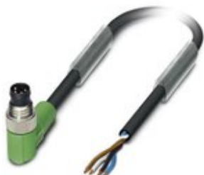
Kabel czujnika/urządzenia wykonawczego, 4-bieg., PCW, czarny RAL 9005, Wtyki kątowe M8, na wolny koniec przewodu, długość kabla: 3 m
