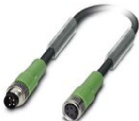
Kabel czujnika/urządzenia wykonawczego, 4-bieg., PCW, czarny RAL 9005, Wtyki proste M8, na Gniazdo proste M8, długość kabla: 3 m
