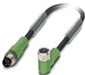
Sensor-/Aktor-Kabel, 4-polig, PVC, schwarz RAL 9005, Stecker gerade M8, auf Buchse gewinkelt M8, Kabellänge: 1,5 m
