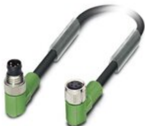
Kabel czujnika/urządzenia wykonawczego, 4-bieg., PCW, czarny RAL 9005, Wtyki kątowe M8, na Gniazdo kątowe M8, długość kabla: 1,5 m
