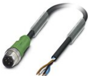
Sensor-/Aktor-Kabel, 4-polig, PVC, schwarz RAL 9005, Stecker gerade M12, Kodierung: A, auf freies Leitungsende, Kabellänge: 1,5 m
