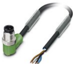
Sensor-/Aktor-Kabel, 4-polig, PVC, schwarz RAL 9005, Stecker gewinkelt M12, Kodierung: A, auf freies Leitungsende, Kabellänge: 1,5 m
