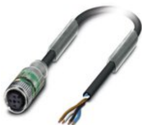
Sensor-/Aktor-Kabel, 4-polig, PVC, schwarz RAL 9005, freies Leitungsende, auf Buchse gerade M12, Kodierung: A, mit 2 LEDs, Kabellänge: 3 m
