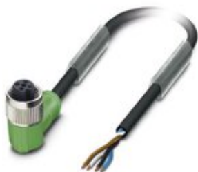
Sensor-/Aktor-Kabel, 4-polig, PVC, schwarz RAL 9005, freies Leitungsende, auf Buchse gewinkelt M12, Kodierung: A, Kabellänge: 1,5 m
