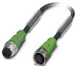
Sensor-/Aktor-Kabel, 4-polig, PVC, schwarz RAL 9005, Stecker gerade M12, Kodierung: A, auf Buchse gerade M12, Kodierung: A, Kabellänge: 0,3 m
