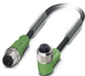
Sensor-/Aktor-Kabel, 4-polig, PVC, schwarz RAL 9005, Stecker gerade M12, Kodierung: A, auf Buchse gewinkelt M12, Kodierung: A, Kabellänge: 3 m
