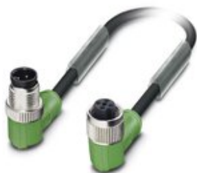
Sensor-/Aktor-Kabel, 4-polig, PVC, schwarz RAL 9005, Stecker gewinkelt M12, Kodierung: A, auf Buchse gewinkelt M12, Kodierung: A, Kabellänge: 3 m
