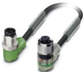
Sensor-/Aktor-Kabel, 4-polig, PVC, schwarz RAL 9005, Stecker gewinkelt M12, Kodierung: A, auf Buchse gewinkelt M12, Kodierung: A, mit 3 LEDs, Kabellänge: 1,5 m
