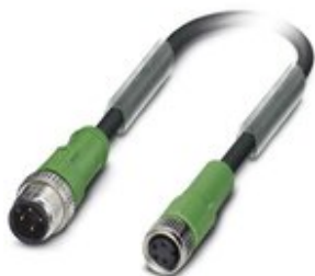
Sensor-/Aktor-Kabel, 4-polig, PVC, schwarz RAL 9005, Stecker gerade M12, Kodierung: A, auf Buchse gerade M8, Kabellänge: 1,5 m
