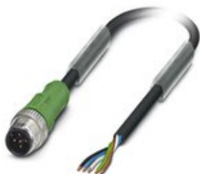
Sensor-/Aktor-Kabel, 5-polig, PVC, schwarz RAL 9005, Stecker gerade M12, Kodierung: A, auf freies Leitungsende, Kabellänge: 3 m
